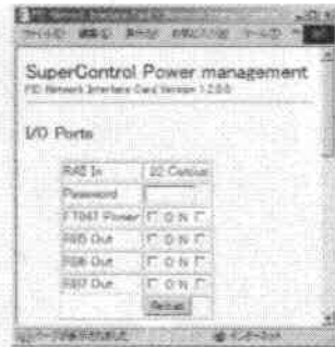
図4 PICマイコンのアセンブリーソースを変更してパスワードによる保護を追加した
